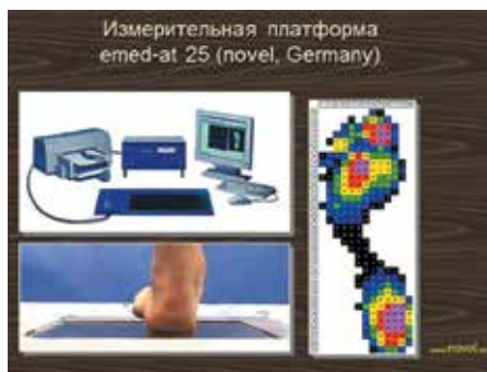
Рис. 4. Измерительный комплекс emed-at для оценки биомеханики стопы
